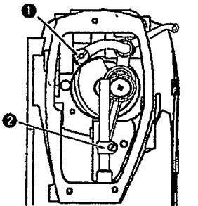
1) 请先卸下挑线连杆销①上的小螺钉后，将润滑脂注满挑线连杆销①的小孔内。
